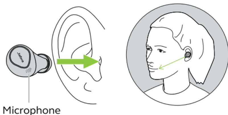
Insérez les écouteurs dans vos oreilles en orientant les microphones vers votre bouche. La tenue doit être légère et confortable. Vous pourriez avoir besoin d'un EarGel de taille différente pour chaque oreille.
