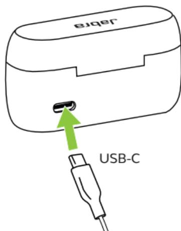
L'étui de recharge utilise une tension USB standard de 5 V +/- 0,25 V. Nous vous déconseillons de recharger les écouteurs avec une alimentation électrique affichant une tension supérieure.
