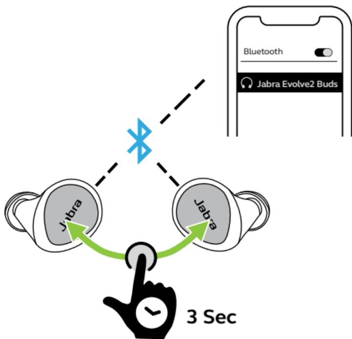
1. Allumez les écouteurs en les retirant de l'étui de recharge. Une autre solution consiste à appuyer simultanément sur les boutons **gauche** et **droit** des écouteurs.
